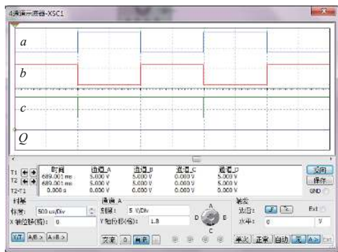
图 8 D 触发器自适应附加脉冲消除电路仿真波形
