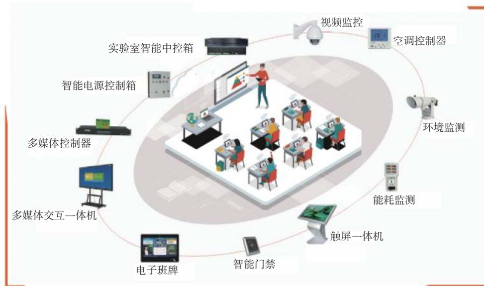
图 1 实验室智能基础设施
