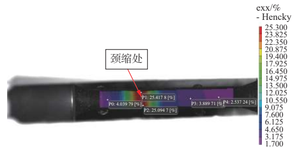
(a) 3D-DIC 法高温下试样应变云图
